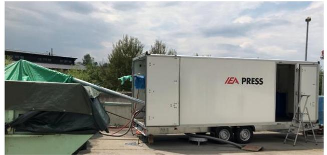
Mit Hilfe des Gerätes kann der Schlamm aus der Kläranlage entwässert werden. Dies reduziert das zu transportierende Volumen sowie das Gewicht. Das getrocknete Granulat wird abtransportiert und der Verbrennung zugeführt. Durch die Gewichts- und Volumenreduzierung können Transportkosten eingespart werden.
