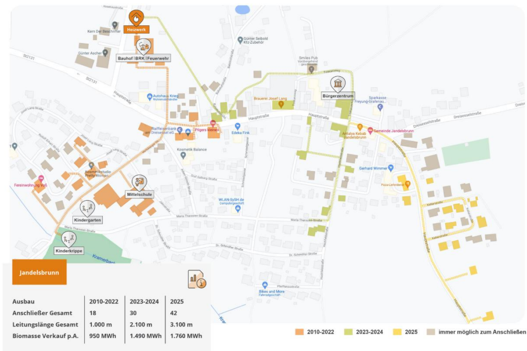
Abbildung 5: Darstellung der bereits bestehenden Fernwärmenetze
